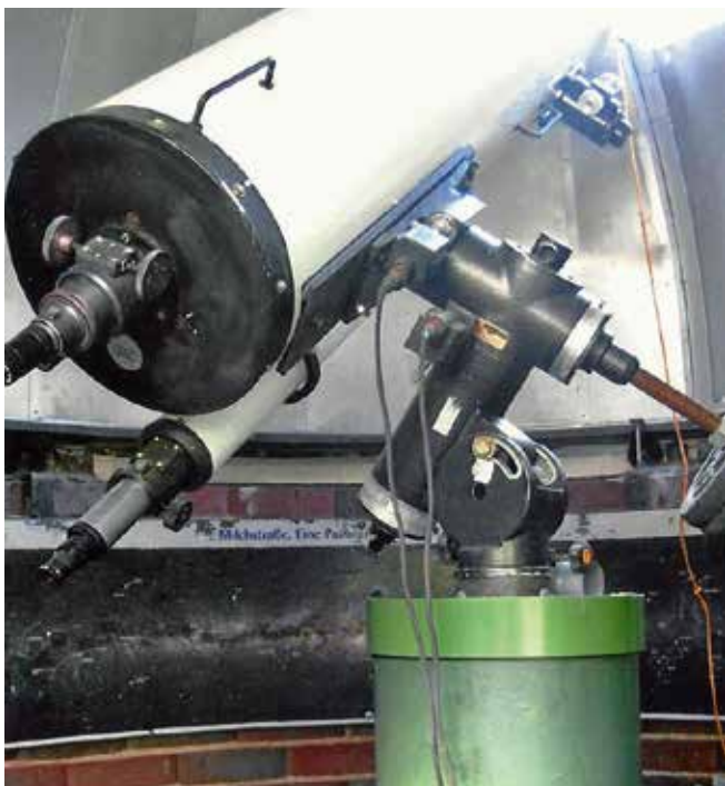
2 Auf der Säule sind ein 10-Zoll-Spiegelteleskop und ein 4-Zoll-Refraktor montiert.
