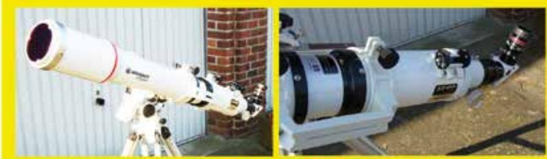
FH 102/1000 mm, mit 100 mm Objektiv ERF. Internes 50 mm Etalon und B1200 mm Blockfiltersystem. Sonnensucher und Zoom Okular.
