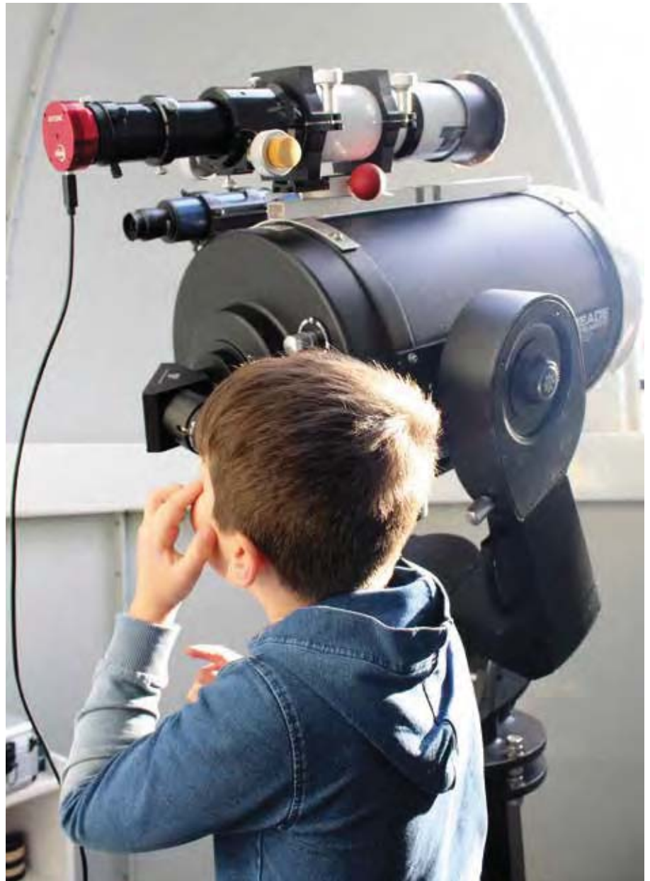
1 Beobachtung des Transits durch das 12-Zoll-Teleskop LX200 von Meade. Darüber ist der Refraktor mit einer Videokamera montiert.
